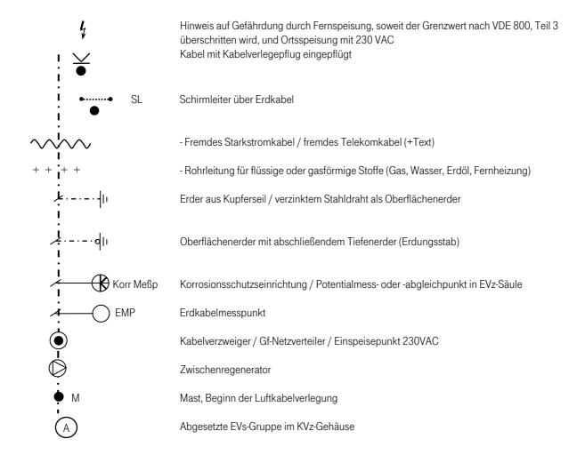
Telekommunikationslinien/-anlagen werden als Einstrichdarstellung im Lageplan dargestellt. Der tatsächliche Umfang der Anlage ist der Legende (Querschnittsdarstellung) zu entnehmen.
